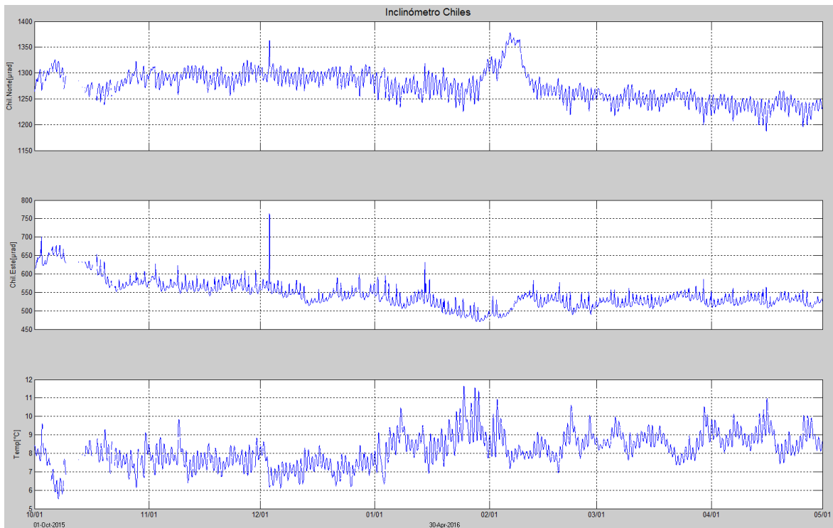
Figura 66. Componentes de inclinación Norte y Este, registro de temperatura del inclinómetro electrónico Chiles, instalado en el volcán del mismo nombre, para el periodo comprendido entre el 1 de octubre de 2015 y el 30 de abril de 2016.
