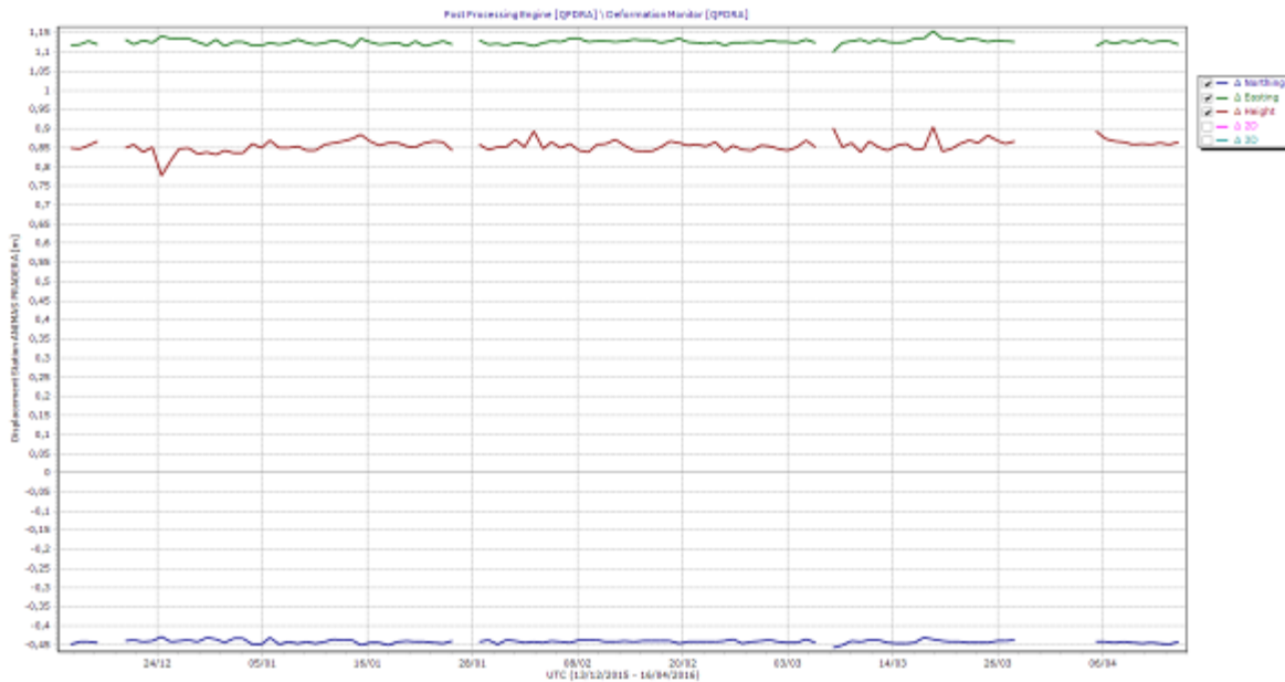
Figura 78. Variaciones en las direcciones Norte, Este y altura de la estación GNSS Pradera instalada sobre la superficie del volcán Las Ánimas, para el periodo comprendido entre el 13 de diciembre de 2015 y el 16 de abril de 2016.
