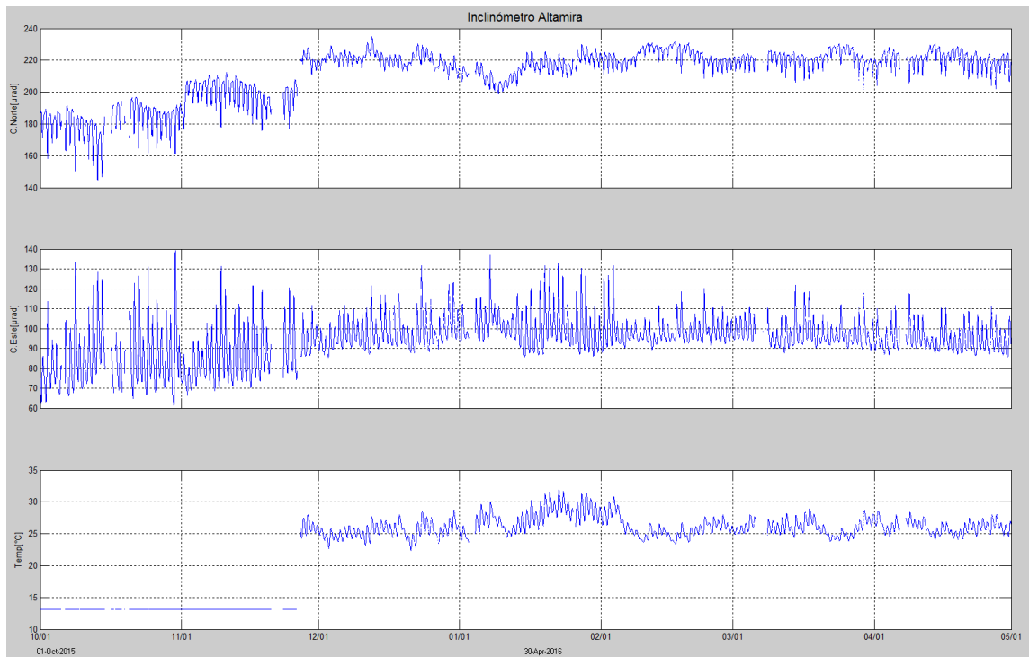
Figura 77. Componentes de inclinación Norte y Este, temperatura del inclinómetro electrónico Altamira, instalado en el límite entre los volcanes Doña Juana y Las Ánimas, para el periodo comprendido entre el 1 de octubre de 2015 y el 30 de abril de 2016.
