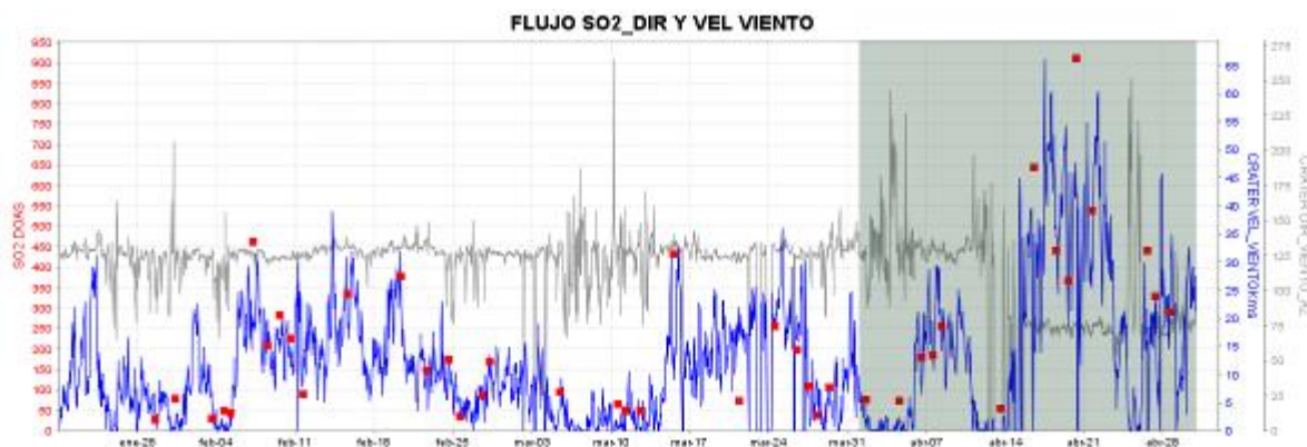
Figura 31. Flujo de emisión de SO 2 , dirección y velocidad del viento para el mes de abril de 2016.
