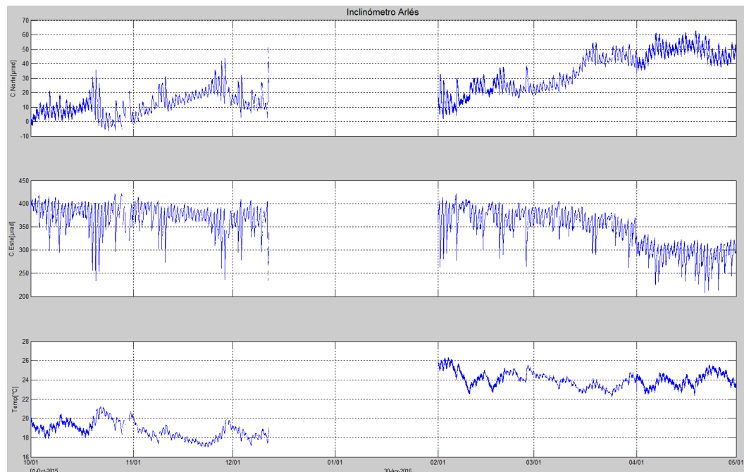
Figura 18. Componentes de inclinación Norte y Este ( \mu\text{rad} ), temperatura del inclinómetro electrónico Arlés, instalado en Galeras, para el periodo comprendido entre el 1 de octubre de 2015 y el 30 de abril de 2016.
