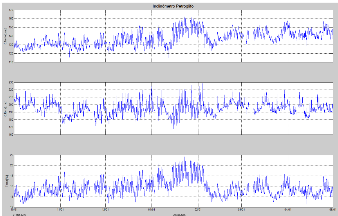
Figura 76. Componentes de inclinación Norte y Este, temperatura del inclinómetro electrónico Petroglifo, instalado en el volcán Las Ánimas, para el periodo comprendido entre el 1 de octubre de 2015 y el 30 de abril de 2016.
